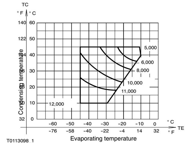
**Fig. 11.4 HCFC/HFC/R290 - TSMC 100 S-L**
